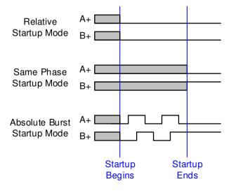
Figure 32: iC-TW28 Startup Modes
